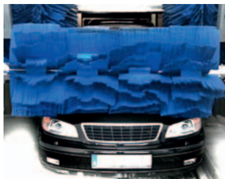
Der topmoderne Drei-Walzen-Trockner im Einsatz.
