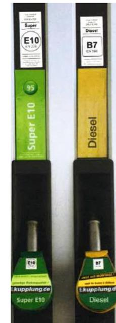
In einigen Orten sind sauerstoffangereicherte Kraftstoffe, die Ether oder Ethanol enthalten, oder neu formulierte Kraftstoffe erhältlich. Diese Kraftstoffe dürfen verwendet werden, sofern Sie die oben beschriebenen Spezifikationen erfüllen. E85 (Ethanolgehalt von 85 %) und andere Kraftstoffe mit einem Ethanolgehalt über 15 % dürfen jedoch nur in FlexFuel-Fahrzeugen verwendet werden.
