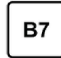
Nur Dieselkraftstoff verwenden, der die Anforderungen von EN 590 erfüllt und einen Schwefelgehalt von maximal 10 ppm aufweist.
