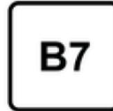
Nur Dieselmotorkraftstoff verwenden, der die Anforderungen von EN 590 erfüllt und einen Schwefelgehalt von maximal 10 ppm aufweist.
